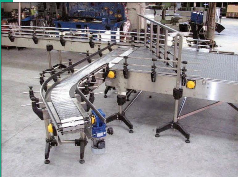
**Componenti di supporto telaio.**
