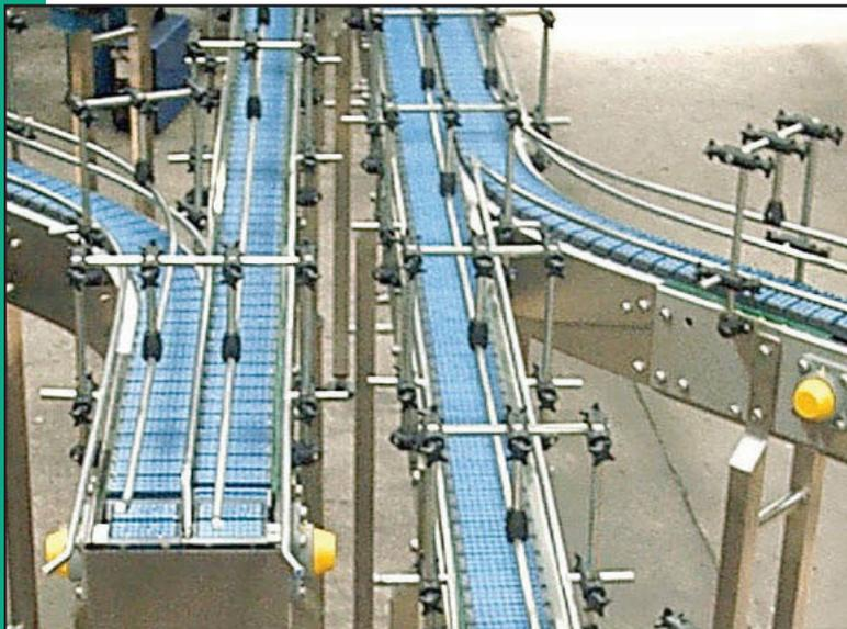
**Sistema di accumulo per prodotti conici. La guida sulla parte superiore offre maggiore stabilità del prodotto.**
