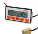
LCD multifunzione con 5 tasti. Visualizzazione dei valori in millimetri, pollici e gradi angolari. Modalità assoluta / incrementale. Alimentazione a batteria. Estrema facilità di montaggio, permette allineamenti e posizionamenti precisi e consente di ridurre al minimo i tempi e le procedure di lavorazione.
