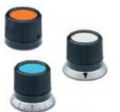
Calottina copribocca in tecnopolimero nei colori standard; flangia in alluminio con indice triangolare o graduazione di precisione. Boccola acciaio brunito, foro alesato H7. Fissaggio con linguetta o spina elastica trasversale oppure per mezzo di viti a pressione. Diametri: 32 - 42 - 48 - 52 - 63 mm
