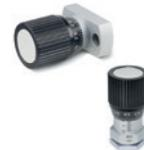
Base in acciaio cromato; manopola in profilato di alluminio zigrinato. Fori per viti di fissaggio paralleli o perpendicolari all'asse dell'albero. Graduazioni con 10 o 15 tratti sulla base cromata e 50 tratti sulla manopola. Diametri: 27 - 34 mm
