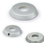
Flangia neutra, con indice triangolare o graduazione (tratti e numeri) in colore nero. Montaggio a mezzo di tre viti autofilettanti. Diametri: 32 - 36 - 40 - 45 - 50 - 56 - 63 mm
