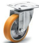
Mozzo con cuscinetti a sfere. Soluzione ideale per carichi elevati e per movimentazioni di tipo continuativo. Supporto in lamiera di acciaio zincato, piastra fissa o girevole con o senza freno. Ottime caratteristiche di scorrevolezza ed elasticità, alta resistenza all'usura e alla lacerazione. Ruota Ø: 80 - 100 - 125 - 150 - 200 mm
