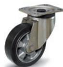
Mozzo con cuscinetti a sfere. Soluzione ideale per carichi elevati e per movimentazioni di tipo continuativo. Supporto in lamiera di acciaio zincato, piastra fissa o girevole, con o senza freno. Ruota Ø: 100 - 125 - 160 - 200 mm
