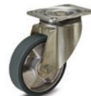
Mozzo con cuscinetti a sfere schermati. Supporto in lamiera di acciaio zincato, piastra fissa o girevole, con o senza freno. Indicate per applicazioni in aree "ESD PROTECTED AREA" dove tutti i componenti sensibili alle scariche elettrostatiche devono essere trattati con il minimo rischio di danneggiamento. Ruota Ø: 125 - 150 - 200 mm
