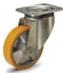
Mozzo con cuscinetti a sfere. Soluzione ideale per carichi elevati e per movimentazioni di tipo continuativo. Supporto in lamiera di acciaio zincato, piastra fissa o girevole, con o senza freno. Ottime caratteristiche di scorrevolezza ed elasticità, alta resistenza all'usura e alla lacerazione. Ruota Ø: 125 - 150 - 200 mm
