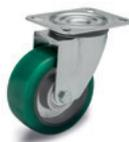
Mozzo con cuscinetti a sfere. Soluzione ideale per carichi elevati e per movimentazioni di tipo continuativo. Supporto in lamiera di acciaio zincato, piastra fissa o girevole, con o senza freno. Ottime caratteristiche di scorrevolezza ed elasticità, alta resistenza all'usura e alla lacerazione. Ruota Ø: 100 mm
