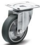
Mozzo con cuscinetti a sfere schermati. Supporto in lamiera di acciaio zincato, piastra fissa o girevole, con o senza freno. Indicate per applicazioni in aree "ESD PROTECTED AREA" dove tutti i componenti sensibili alle scariche elettrostatiche devono essere trattati con il minimo rischio di danneggiamento. Ruota Ø: 80 - 100 - 125 - 150 - 200 mm
