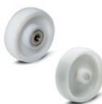
Mozzo con foro passante e cuscinetti a sfere. Soluzione ideale per carichi elevati e per movimentazioni di tipo continuativo. Ottima resistenza all'usura e alla lacerazione. Ruota Ø: 65 - 80 - 100 - 125 - 150 - 200 mm
