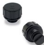
Coperchio in tecnopolimero; raccordo filettato e frangiloio esterno. Rondella piana in gomma NBR. Con o senza filtro aria. Temperatura massima di esercizio in continuo: 80° C. Diametri: 30 - 40 - 57 mm. Filettature GAS: 1/4 - 3/8 - 1/2 - 3/4 - 1 - 1 1/4 - 1 1/2. Filettature metriche (passo 1.5): M16 - M18 - M20 - M22 - M24 - M26 - M30
