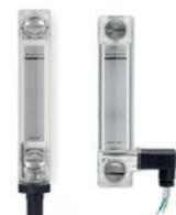
Viti, dadi e rondelle in acciaio zincato. Guarnizioni di tenuta a gradino per la tenuta sulla parete del serbatoio e OR sottotesta della vite in gomma sintetica NBR. Squadretta con connettore maschio o femmina in tecnopolimero. Sensore con uscita laterale o assiale. Disponibili con contatto elettrico NO o NC. Interassi di fissaggio: 76 - 127 - 254 mm
