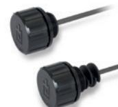
Raccordo filettato e frangiloio esterno. Rondella piana in gomma NBR. Astina di livello in acciaio fosfatato. Con o senza filtro aria. Temperatura massima di esercizio in continuo: 80° C. Diametri: 30 - 40 - 57 mm. Filettature GAS: 1/4 - 3/8 - 1/2 - 3/4 - 1 - 1 1/4 - 1 1/2. Filettature metriche (passo 1.5): M16 - M18 - M20 - M22 - M24 - M26 - M30
