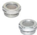
Filtro in retina di acciaio INOX AISI 304 con contorno in tecnopolimero. Rondella piana in gomma sintetica NBR. Temperatura massima di esercizio in continuo: 100° C.
