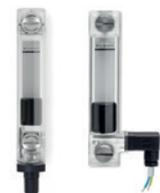
Viti, dadi e rondelle in acciaio zincato. Guarnizioni di tenuta a gradino per la tenuta sulla parete del serbatoio e OR sottotesta della vite in gomma sintetica NBR. Galleggiante in tecnopolimero con elemento magnetico per l'attivazione del contatto. Squadretta con connettore maschio o femmina in tecnopolimero. Sensore con uscita laterale o assiale. Disponibili con contatto elettrico NO, NC o SW. Interassi di fissaggio: 76 - 127 - 254 mm
