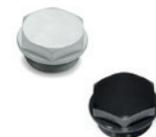
Rondella piana in gomma sintetica NBR. Esecuzioni standard: alluminio naturale o anodizzato in colore nero. Temperatura massima di esercizio in continuo: 100° C. Filettature metriche: M14 - M16 - M20 - M26 - M33 - M42
