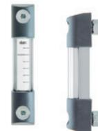
Terminali di fissaggio in tecnopolimero. Armatura in alluminio. Protezione frontale trasparente in policarbonato. Visiera di livello a colonna tubo trasparente in vetro borosilicato. Mostrina in alluminio laccato bianco. Viti, dadi e rondelle in acciaio INOX AISI 316. Guarnizioni di tenuta in silicone VMQ Rosso. Materia prima idonea al contatto con alimenti (FDA CFR.21).
