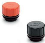
Coperchio in tecnopolimero arancio o nero. Raccordo filettato in colore nero. Rondella piana in gomma sintetica NBR. Valvola: con taratura a 10 mb o 100 mb. Temperatura massima di esercizio in continuo: 100° C. Filettature metriche (passo 1.5): M12 - M14 - M16 - M18 - M20 - M22. Filettature GAS: 1/4 - 3/8 - 1/2 - 3/4 - 1
