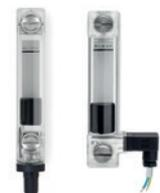
Viti, dadi e rondelle in acciaio zincato. Guarnizioni di tenuta a gradino per la tenuta sulla parete del serbatoio e OR sottotesta della vite in gomma sintetica NBR. Galleggiante in tecnopolimero con elemento magnetico per l'attivazione del contatto. Squadretta con connettore maschio o femmina in tecnopolimero. Sensore con uscita laterale o assiale. Disponibili con contatto elettrico NO o NC. Interassi di fissaggio: 76 - 127 - 254 mm
