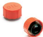
Coperchio in tecnopolimero colore arancio; raccordo filettato nero. Montaggio a pressione su tubi. Filtro d'aria anulare in schiuma di poliuretano. Temperatura massima di esercizio in continuo: 100° C.
