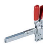
Bussole di supporto in acciaio temprato e rettificato. Impugnatura in poliuretano colore rosso. Rivestimento leva anti sgancio in polivinilcloruro (PVC). La speciale prolunga del braccio di bloccaggio favorisce l'impiego specifico in dime di controllo.
