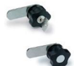
Statore e rotore in lega di zinco pressofusa; Due chiavi in ottone nichelato, estraibili in due posizioni a 180° (serratura aperta o chiusa). Apertura a destra o a sinistra; serratura con cifratura differenziata, unica, differenziata o senza serratura. Diametro volantino: 40 mm
