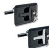
Maniglia colore nero o grigio. Esecuzioni standard: serratura a cifratura differenziata o a cifratura unica. Montaggio a mezzo 4 viti in acciaio zincato costampate nella base. Il ribaltamento della maniglia nell'apposita sede trasla assialmente l'albero con la leva in direzione del battente fino alla posizione di blocco.
