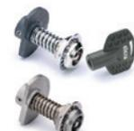
BOCK: prigioniero in acciaio nichelato; bussola di guida e ghiera di bloccaggio in ottone nichelato; camma in acciaio sinterizzato e indurito; molla in acciaio zincato. BOCK-SST: prigioniero, bussola di guida, ghiera di bloccaggio, camma e molla in acciaio INOX. Apertura a destra o a sinistra. Lunghezze: 46 - 54 - 64 mm
