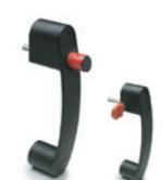
Chiave a profilo antintrusione. Perno in acciaio INOX AISI 304 con pulsante in tecnopolimero. Fori passanti per viti a testa cilindrica con cava esagonale. Interasse di fissaggio: 132 mm
