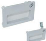
Maniglia colore nero o grigio. Esecuzioni standard: innesto chiave triangolare, quadro 7x7 o a due alette, posizionato a destra o sinistra. Montaggio a mezzo 5 viti in acciaio zincato. Levetta di chiusura GN 115 in acciaio zincato. Dimensione: 128 mm, campo di regolazione da 13 a 75 mm
