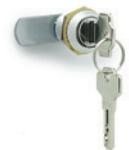
Serratura con chiave a doppia trancia a profilo interno. Statore e rotore in lega di zinco cromata. Rotazione 180°. Serratura a cifratura differenziata o a cifratura unica. Grado di protezione IP 65. Dimensioni: 22.5 - 27.5 mm
