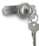
Statore e rotore acciaio INOX AISI 316L, levetta, rondella e rosetta in acciaio zincato. Due chiavi in ottone nichelato estraibili in due posizioni a 180°. Serratura a cifratura differenziata o a cifratura unica. Dimensioni: da 13 a 30 mm
