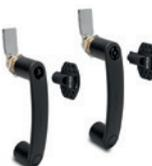
Rotore in tecnopolimero, ghiera di bloccaggio e levetta di chiusura in lega di zinco. Boccola in ottone, foro cieco filettato con innesto triangolare o a due alette per chiave. Rotazione 90°. Interasse di fissaggio: 117 mm
