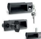
Esecuzioni standard: serratura, con chiave estraibile in due posizioni, rotazione 90°, posizionata a destra o sinistra. Cifratura unica, differenziata o differenziata con chiave passe-partout oppure chiusura tipo quadri elettrici con innesto triangolare, quadrato o a due alette.
