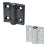
Rivestimento corpo in resina epossidica. Montaggio mediante fori passanti con sede per viti a testa svasata piana. Angolo di rotazione max  $270^\circ$  ( $-90^\circ$  e  $+180^\circ$  con  $0^\circ$  = complanarità delle superfici). Dimensioni: 40 - 50 - 60 mm
