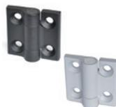
Rivestimento corpo in resina epossidica. Elementi guida in tecnopolimero a base acetilica (POM). Montaggio mediante fori passanti con sede per viti a testa svasata piana. Angolo di rotazione max 270° (-90° e +180° con 0° = complanarità delle superfici). Dimensioni: 60 mm
