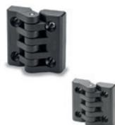
Perno di rotazione in acciaio INOX AISI 303. Montaggio mediante boccole ottone nichelato, foro filettato; prigionieri filettati in acciaio nichelato; fori e asole (CFA-SL) passanti per viti a testa cilindrica. Angolo di rotazione max 215° (-35° e +180° con 0° = complanarità delle superfici). Dimensioni: 40 - 49 - 65 - 97 mm
