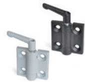
Maniglia in lega di zinco pressofusa, colore nero o grigio. Bussola di guida in tecno polimero. Dado con foro cieco filettato in acciaio, contornato da tecno polimero. Montaggio mediante fori passanti con sede per viti a testa svasata piana. Angolo di rotazione max  $270^\circ$  ( $-90^\circ$  e  $+180^\circ$  con  $0^\circ$  = complanarità delle superfici). Dimensioni: 60 mm
