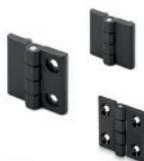
Perno di rotazione in acciaio INOX AISI 303. Montaggio mediante prigionieri filettati in acciaio; fori passanti per viti a testa svasata o a testa cilindrica; asole con foro passante per viti a testa cilindrica. Angolo di rotazione max 270° (-90° e +180° con 0° = complanarità delle superfici). Dimensioni: 30 - 40 - 50 - 60 mm
