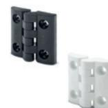
Perno di rotazione in tecnopolimero. Montaggio mediante fori passanti per viti a testa svasata piana, a testa cilindrica, a testa esagonale o dadi. Angolo di rotazione: max 200° (-20° e +180° con 0° = complanarità delle superfici interconnesse). Dimensioni: 40 - 49 - 65 mm
