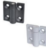
Montaggio mediante fori passanti con sede per viti a testa svasata piana. Posizioni di scatto con angolo  $-90^\circ / 0^\circ / 90^\circ / 180^\circ$  coppia resistente 1 Nm. Posizioni di scatto con angolo  $-3^\circ / 117^\circ$ , coppia resistente 1 Nm. Angolo di rotazione max  $270^\circ$  ( $-90^\circ$  e  $+180^\circ$  con  $0^\circ$  = complanarità delle superfici). Dimensioni: 60 mm
