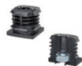
Dado DIN 934 in acciaio zincato lucido. Le due parti del terminale sono connesse fra di loro tramite due spine che trovano alloggiamento in apposite contro-sedi. Una cavità predisposta nella parte interna del terminale accoglie un dado esagonale DIN 934. Filettature: M6 - M8 - M10 - M12 - M16
