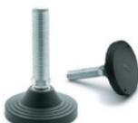
Base con o senza disco antiscivolo in gomma sintetica NBR. Stelo filettato passante articolato in acciaio zincato lucido con esagono di regolazione. Fissaggio stelo/base con vite e rondella in acciaio zincato. A richiesta dado in acciaio zincato. Basi Ø: 125 mm
