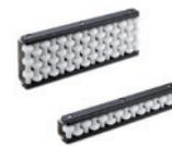
Guide con una, due, tre o quattro file di rullini. Profilato in acciaio INOX AISI 304. Supporto perni e rullini in tecnopolimero a base acetale. Perni in acciaio INOX AISI 304. Con rullini sagomati, zona di contatto cilindrica. Sono strutture autoportanti particolarmente solide, adatte per la movimentazione di prodotti di peso e dimensioni rilevanti.
