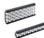
Guide con una, due, tre o quattro file di rullini. Profilato in acciaio zincato. Supporto perni e rullini in tecnopolimero a base acetale. Perni in acciaio INOX AISI 304. Con rullini sagomati, zona di contatto cilindrica. Sono strutture autoportanti particolarmente solide, adatte per la movimentazione di prodotti di peso e dimensioni rilevanti.
