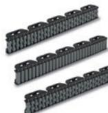
Struttura autoportante e rullini in tecnopolimero. Perni in acciaio INOX AISI 304. Con rullini cilindrici o sagomati, zona di contatto sferica o cilindrica. Servono a guidare lateralmente sui nastri trasportatori prodotti di ingombro verticale contenuto.
