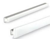
Profilo guida in tecnopolimero. Supporto in acciaio INOX AISI 304. Larghezza della superficie di contatto di circa 12 o 32 mm. Servono per guidare lateralmente sui nastri trasportatori prodotti aventi ingombri diversi, senza lasciare tracce sui recipienti.
