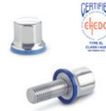
Guarnizione di tenuta in gomma sintetica H-NBR o in EPDM, conformi FDA. Con foro cieco filettato o con vite filettata. Sono accessori per il fissaggio dei piedini di livellamento destinati all'uso in ambienti dove è richiesto un elevato grado d'igienicità. Filettature: M4 - M5 - M6 - M8 - M10 - M12 - M16 - M20
