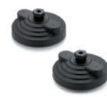
Base con o senza disco antiscivolo in gomma NBR. Fissaggio a terra per mezzo di 2 fori a 180° forniti chiusi da un diaframma. Utilizzati per il fissaggio diretto mediante viti standard, senza la necessità di uno stelo filettato.
